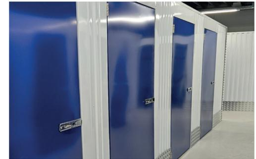
**PROFIL-TÜR.** Diese Profil-Tür besteht aus Trapezblechplatten, die in einem umlaufenden Rahmen eingefasst ist und durch innenseitige Kreuzverstreben stabilisiert wird. Die Tür ist kratzfest pulverbeschichtet und in fast allen RAL-Farben erhältlich.
